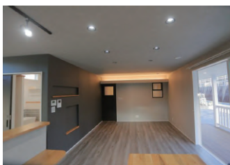
▲リビングとウッドデッキの間に大きな掃き出し窓。それでも冬は暖かいのは、複層ガラスの断熱性のおかげです。
